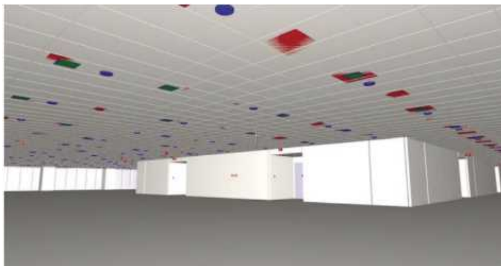
図 9 BIM モデルを利用した電気・空調・防災設備の位置の検討
