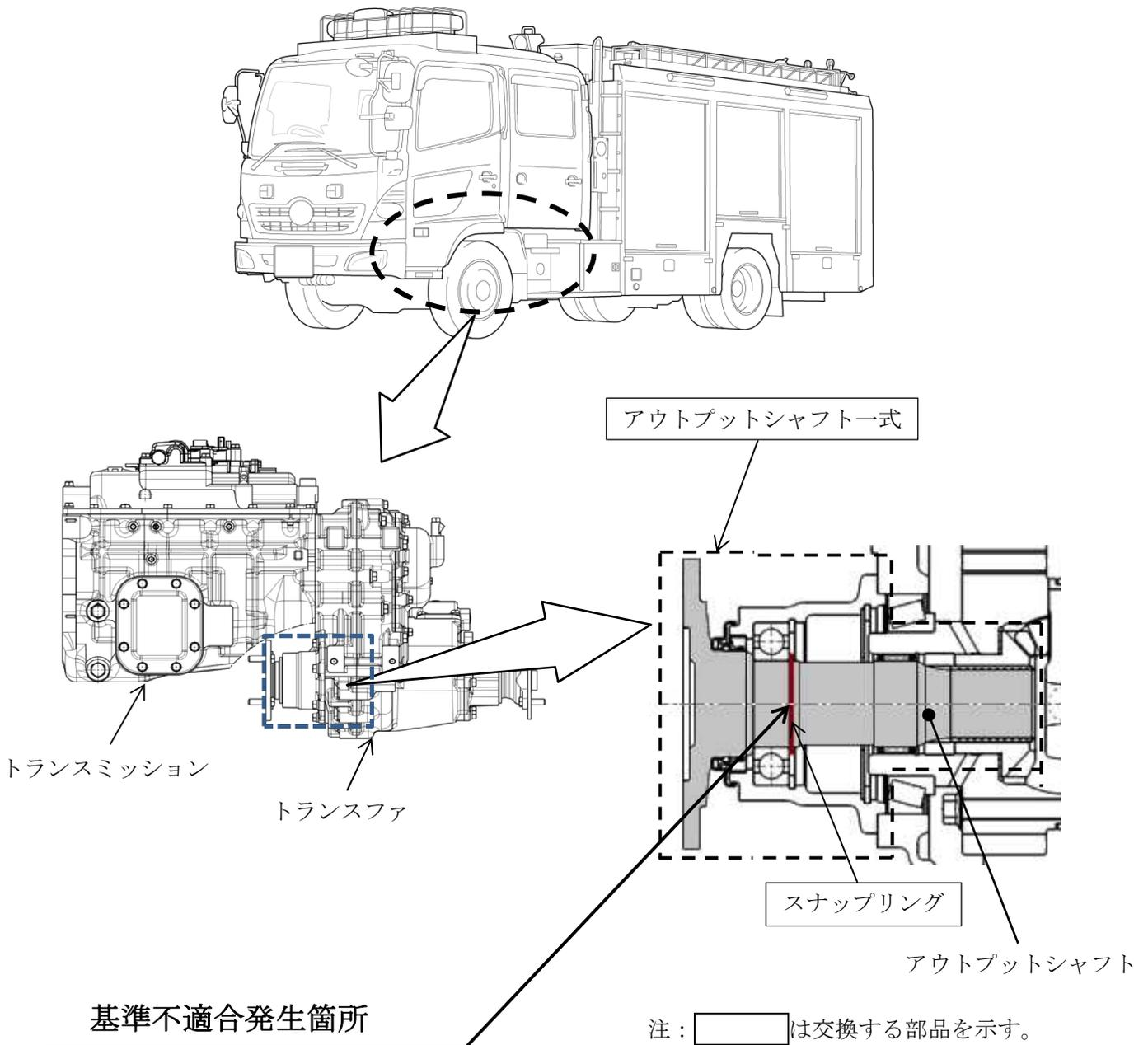
消防車、塵芥車及びタンクローリ仕様の四輪駆動式中型トラックにおいて、トランスファのアウトプットシャフト抜け出し防止用スナップリングの強度が不足しているため、急発進を繰り返すと当該リングが折損することがある。そのため、アウトプットシャフトがトランスファから抜け出し、スプラインの嵌合が外れ前輪に駆動力を伝達できなくなり、走行不能となるおそれがある。
