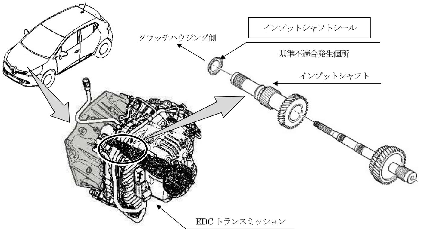
注:  は交換する部品を示す。EDC トランスミッションの塗りつぶし部分はクラッチハウジングを示す。
