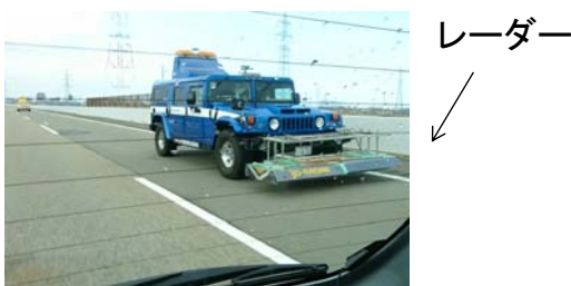
時速80kmの高速で地中からの反射波の非接触計測が可能。
