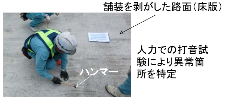
車線規制+打音試験 → 膨大な時間とコスト
