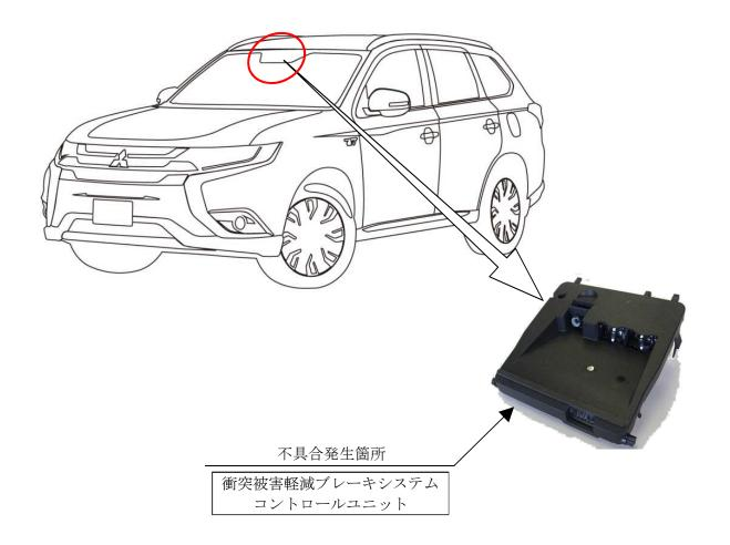
衝突被害軽減ブレーキシステムにおいて、コントロールユニットの制御プログラムが不適切なため、 前方に衝突可能性がある歩行者を検知した際のブレーキ作動時間が必要以上に長くなることがある。 そのため、運転者の不要な制動操作による急制動を誘発するおそれがある。
