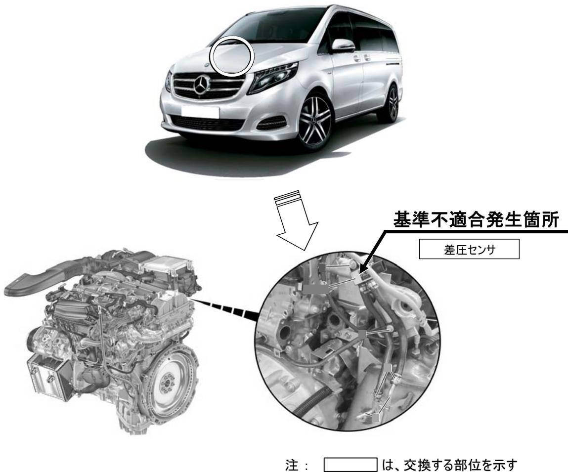
排気ガスの差圧センサ製作時において、センサ出力の公差設定が不適切なため、使用過程においてエンジンコントロールユニットが故障を検出するものがある。そのため、エンジン警告灯(MIL)が点灯し、排気ガス浄化装置(DPF)及び排気ガス再循環装置(EGR)が停止して、保安基準第31条の基準に適合しなくなるおそれがある。
