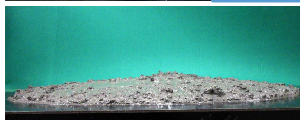
分離気味のコンクリートのスランプフロー状況 (中心部に粗骨材が偏在している)
