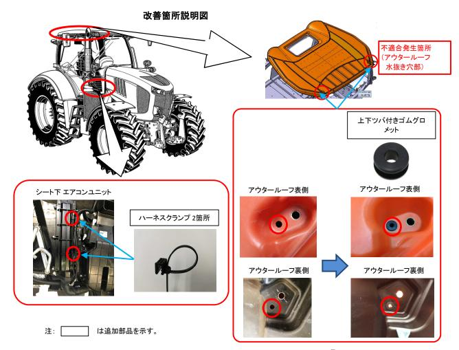
農耕トラクタのアウタールーフにおいて、成形時に樹脂間の溶着が不十分なため、水抜き穴加工の際に、溶着部に亀裂が入ることがある。そのため、当該亀裂からアウタールーフ内部に雨水等が侵入し、キャビン床下に溜まり、最悪の場合、エアコンブロアモータハーネスがショート、発火して、火災に至るおそれがある。
