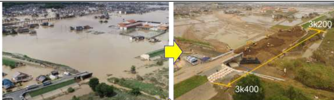
7月7日(土)22:00 緊急対策工事に着手 欠け口工完了済 7月8日(日)14:00道掘削
