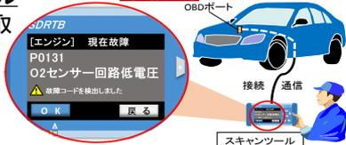
法定スキャンツールを接続して「特定DTC」が検出された場合、検査不合格
