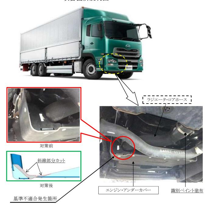
大型トラックの冷却装置において、ラジエータロアホースの組付け方法が不適切なため、当該ホースとエンジンアンダーカバーの隙間が狭いものがある。そのため、当該ホースが膨張した場合、エンジンアイドリング時においてエンジンアンダーカバーが振動することにより双方が干渉して、当該ホースが損傷することがある。そのままの状態で使用を続けると、当該ホースに亀裂が生じ冷却水が漏れ、そのため、最悪の場合、オーバーヒートに至るおそれがある。
