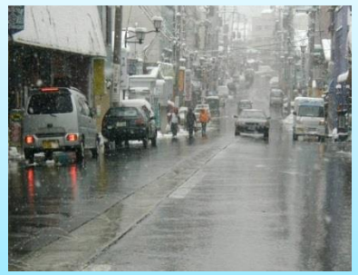
下水処理水を活用した消雪
