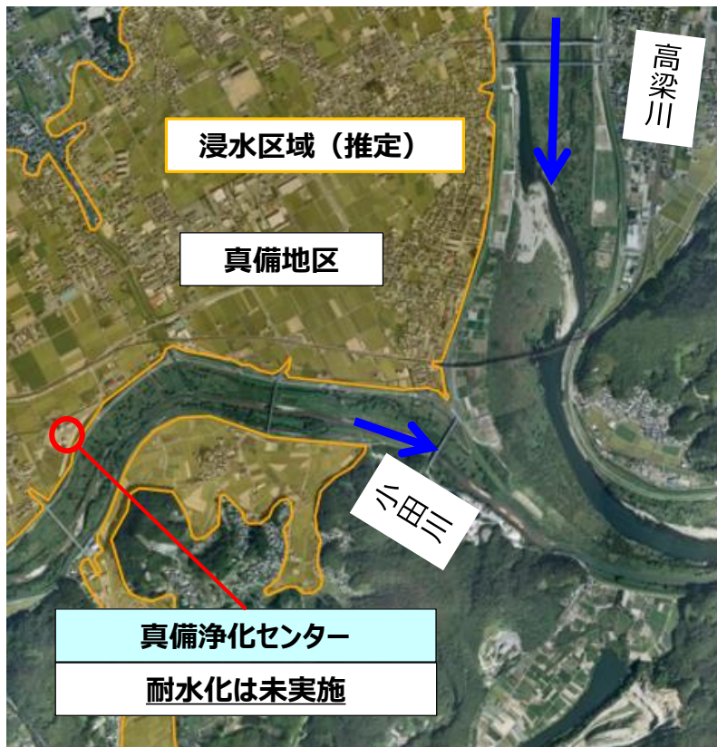
今回の豪雨において河川氾濫により下水処理場が浸水し機能停止したが、被災後3日後には最低限の下水処理機能を確保した事例。(岡山県倉敷市)
