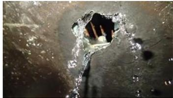
管体破損(5cm四方の穴)
