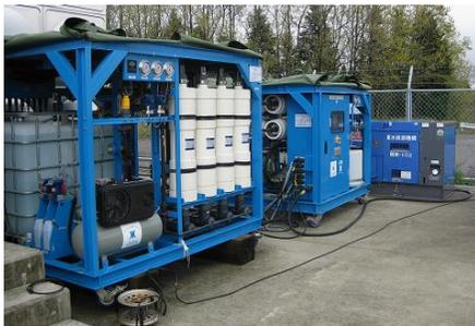
可搬式浄水装置(水資源機構)
