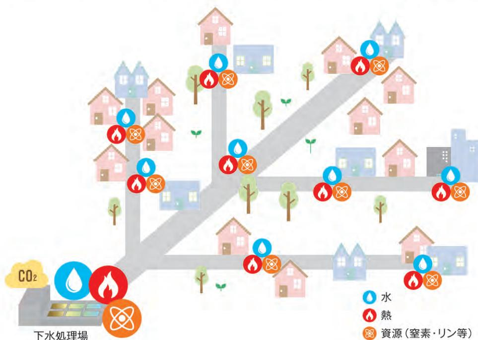
家庭等から出る水や資源(窒素・リン等)、さらには熱が下水管を通じて下水処理場に集まります。窒素・リンは肥料の三大要素の一つで、農業に有用です。また、下水処理場では処理の過程でCO<sub>2</sub>を排出していますが、CO<sub>2</sub>も植物の生長にとって欠かすことのできない光合成に必要な要素です。
