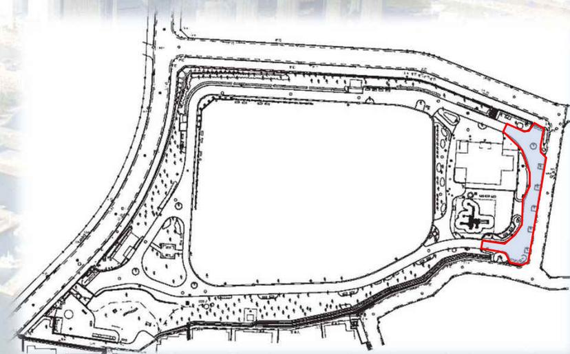
公園内植栽の根上り対策等の修繕に合わせ、透水性舗装に改良し、保水・浸透機能を高めます。
