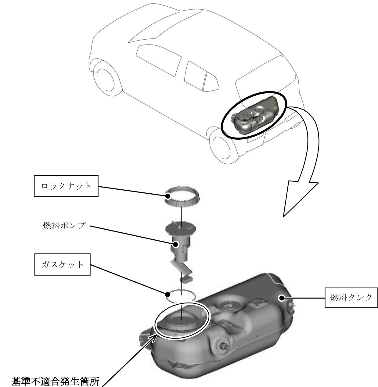
燃料タンクにおいて、樹脂成形時の冷却が不十分であったため、燃料ポンプ取り付けねじ部に成形不良が生じ、燃料ポンプを取り付けた状態でのシール性能が低下するものがある。そのため、満タン時に当該部から燃料が漏れるおそれがある。
