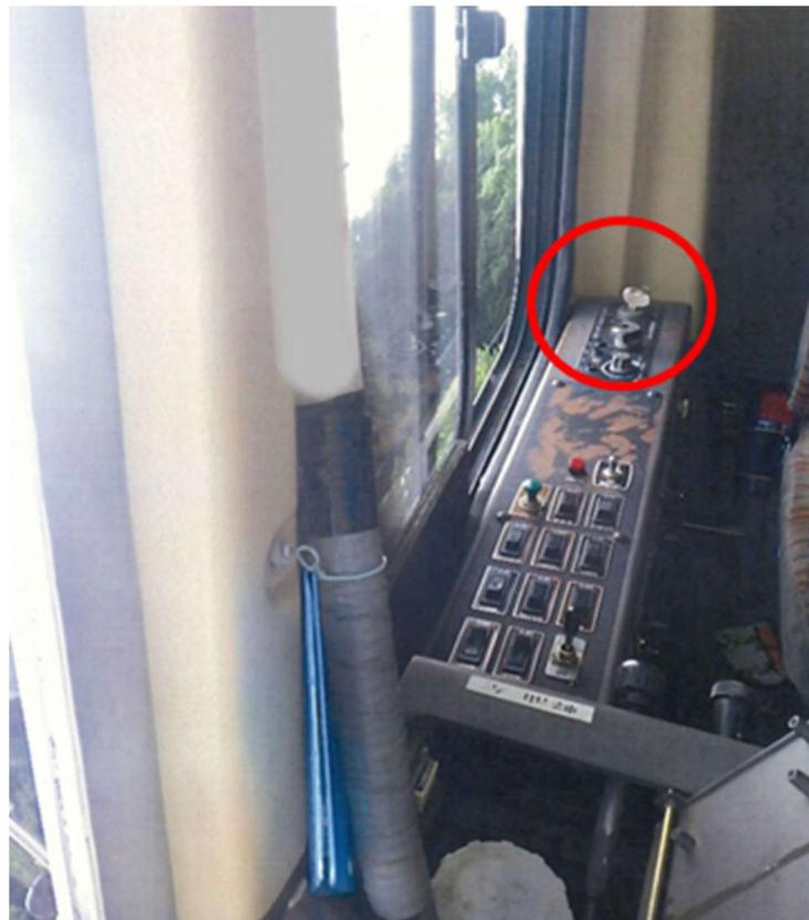
写真7-2 運転席右側（○はエアコンの温度調節パネルの位置）
