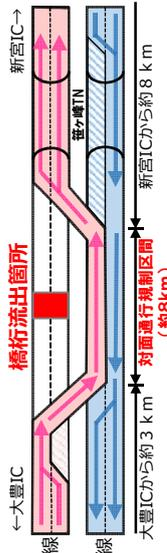
橋桁が流出する大規模被災だったが、4車線であったため、下り線を活用し交通機能確保
