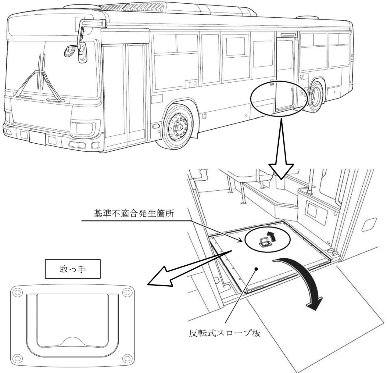
バスの中扉出入口に設置してある反転式スロープ板において、取っ手の部品寸法が不適切なため、取っ手を操作した際、取っ手が突出するものがある。そのため、乗客が当該取っ手につまずいて転倒するおそれがある。
