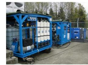
可搬式浄水装置((独)水資源機構)
