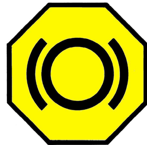
ブレーキフルードの種類を示したラベル (非鉱物油を示す)
