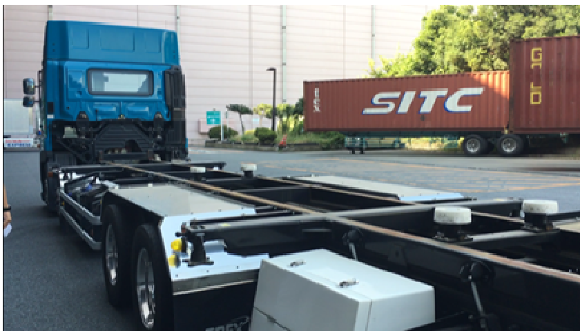
【図１－２：脱着中のスワップボディコンテナ車両②】
