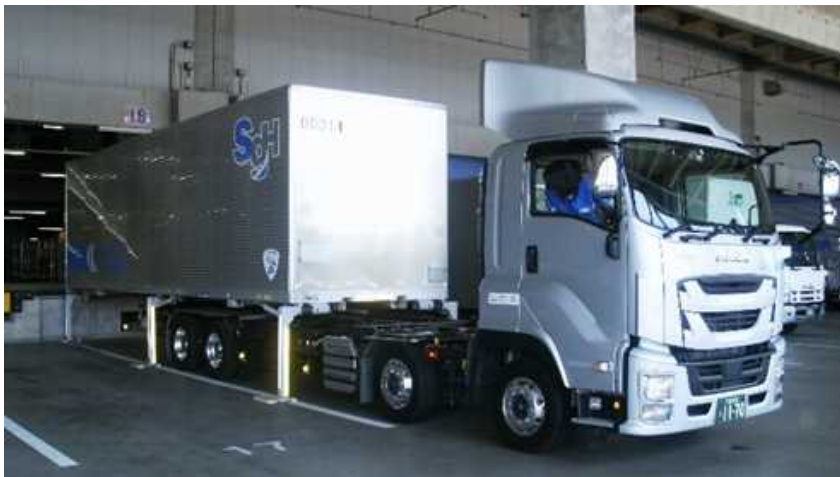
【図１－１：脱着中のスワップボディコンテナ車両①】
