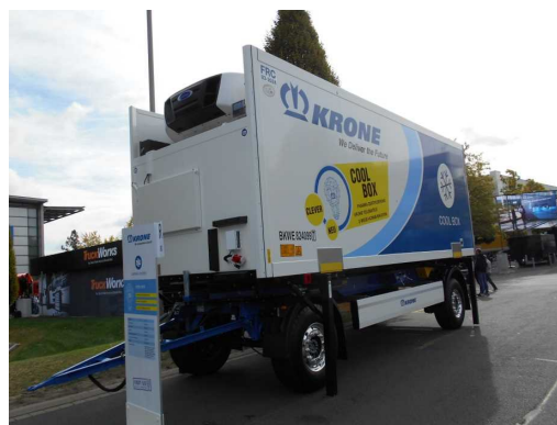
【図5－4：欧州の冷蔵・冷凍対応されたスワップボディコンテナ車両～第2回検討会日本トレクス(株)作成資料より抜粋】
