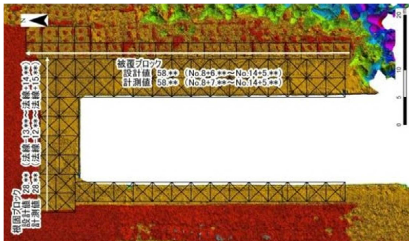
3次元平面図における出来形の計測イメージ
