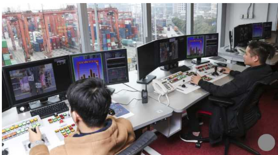
管理棟での遠隔操作の様子
