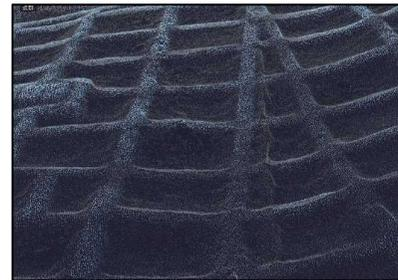
法面に対して鉛直方向の離れを厚さとして算出
