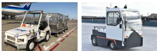
【現行の有人タイプトーイングトラクター及び牽引貨物（写真左）、テストで使用するトーイングトラクター（写真右）】
