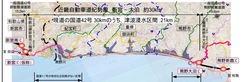
図5 津波浸水区域を通過する国道42号
