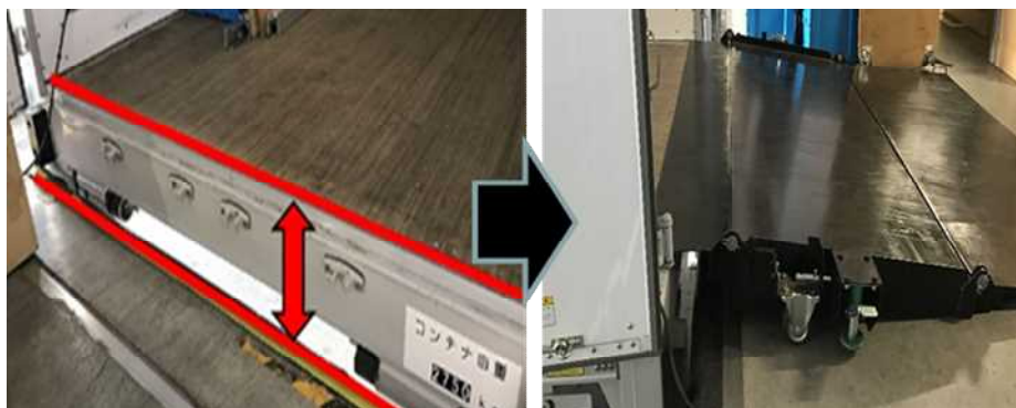
【図1-9：バース高とコンテナ高の段差と解消事例～第1回検討会(株)ホームロジスティクス作成資料より抜粋】
