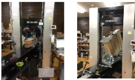
※スクリーウ単体の性能試験状況
