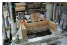
※接合部位の性能試験(せん断)
