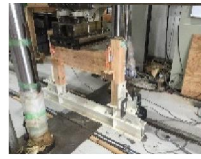
※接合部位(柱・梁)のせん断試験状況
