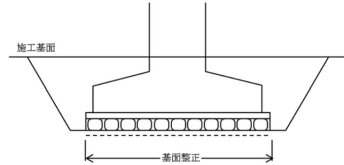
図 3-1 基面整正の計上部分
