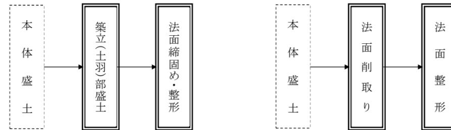
図3-2 盛土部施工フロー図
