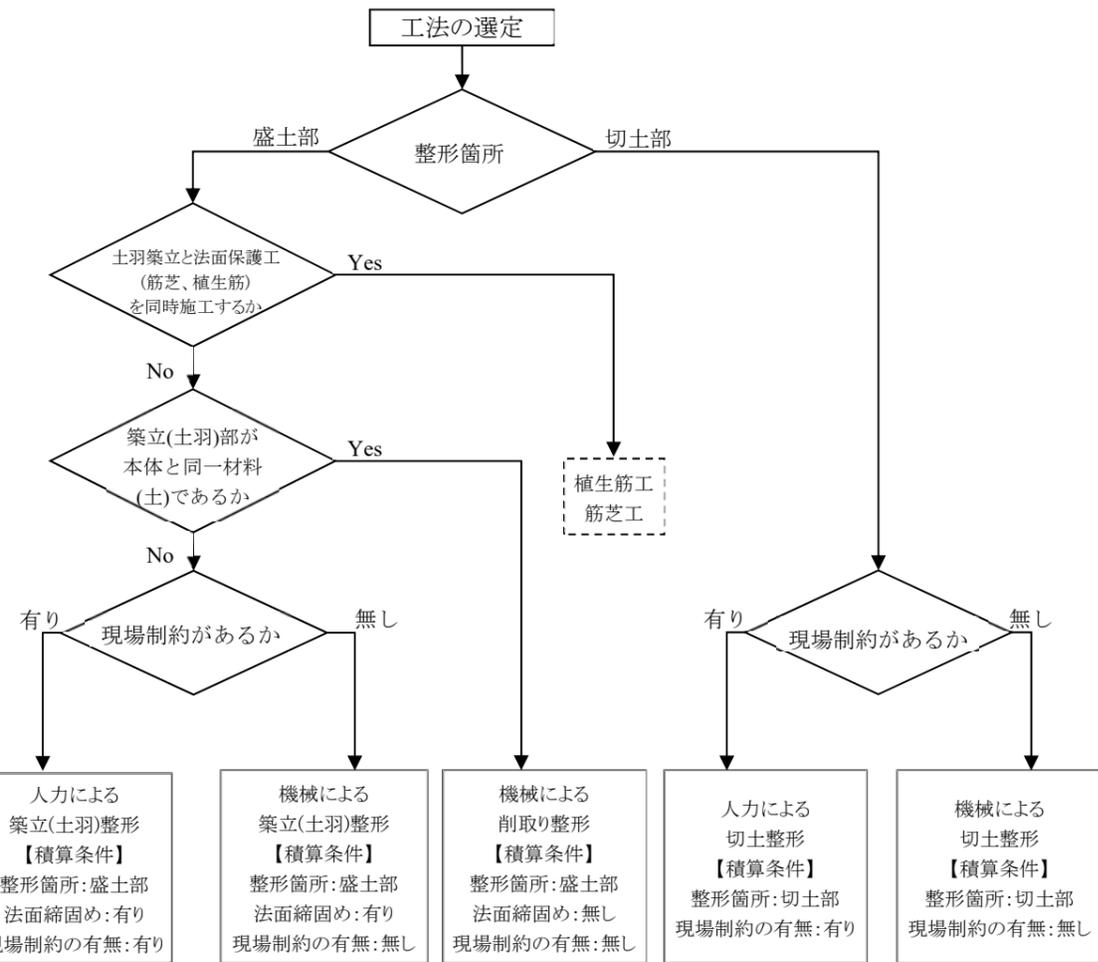
図 3-1 法面整形工 工法選定フロー図
