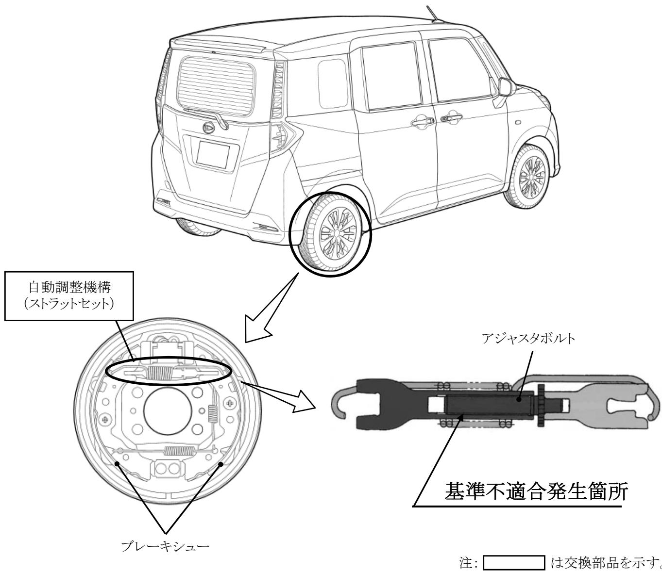
後輪ブレーキのシューとドラムの隙間を自動で調整する機構(ストラットセット)において、部品組立時のグリス塗布作業が不適切なため、アジャスターボルトのネジ面にグリスが塗布されていないものがある。そのため、そのままの状態で使用を続けると、ネジ面が錆びて固着し、自動調整機構が作動しないなるおそれがある。
