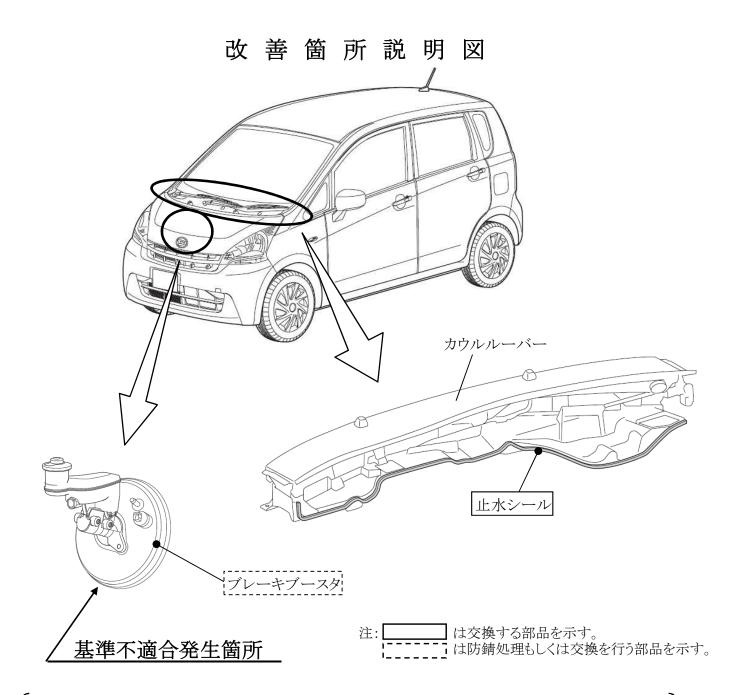
カウルルーバーとダッシュパネルの合わせ部の止水処理が不適切なため、雨水等がブレーキブースタに滴下するものがある。そのため、ブレーキブースタに錆が発生し、そのままの状態で使用を続けると、錆が早期に進行して、最悪の場合、ブレーキブースタに穴があき、ブレーキペダルの操作力が増大し、制動距離が長くなるおそれがある。
