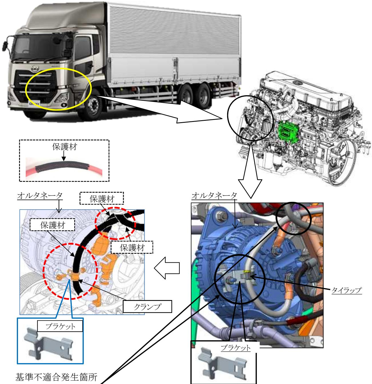
150アンペア仕様のオルタネータ電源配線において、オルタネータ裏側の配索及び固定方法が不適切なため、振動により当該配線が固定ブラケットのエッジ部と干渉して被覆を損傷せざるを得ない。そのため、そのままの状態で使用を続けると、当該配線が短絡し発熱・発煙するおそれがある。
