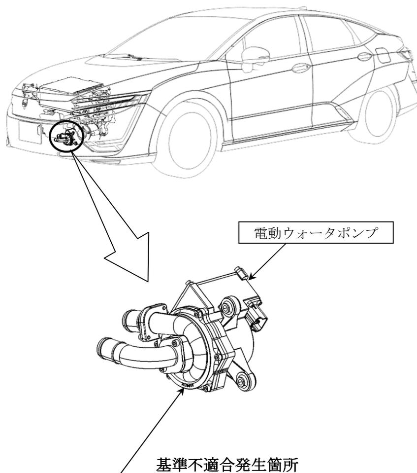
燃料電池システムを冷却する電動ウォーターポンプにおいて、駆動用モータの磁石の表面処理が不適切なため、冷却水により磁石が腐食することがある。そのため、そのまま使用を続けると腐食が進行し、電動ウォーターポンプが作動しなくなり、パワーモードオン時に警告灯、警告表示が点灯し、燃料電池システムが起動しない。または、走行中に警告灯、警告表示が点灯し、燃料電池システムが停止して、最悪の場合、走行不能となるおそれがある。
