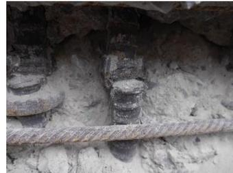
写真 3.5-2 溶接部が破断した柱主筋
