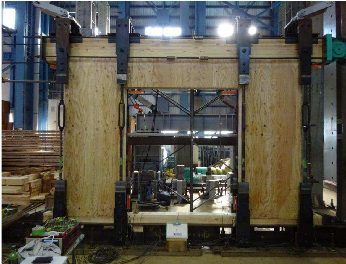
写真5.1-1 試験体設置時の様子
