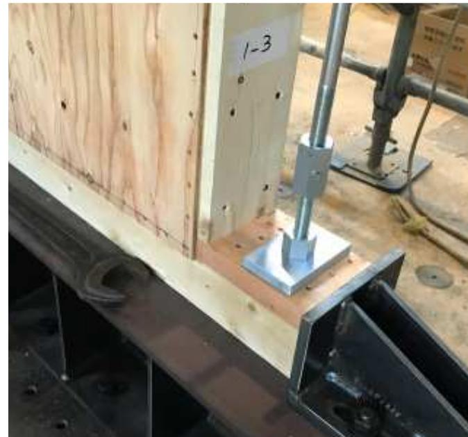
写真5.2-3 タイダウン設置例
