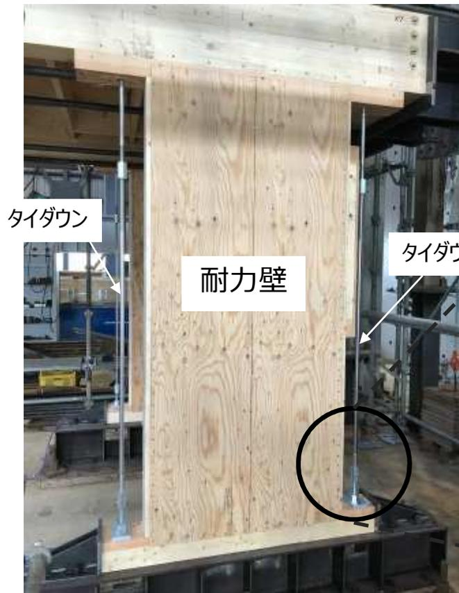
写真5.2-1 タイダウン設置例
