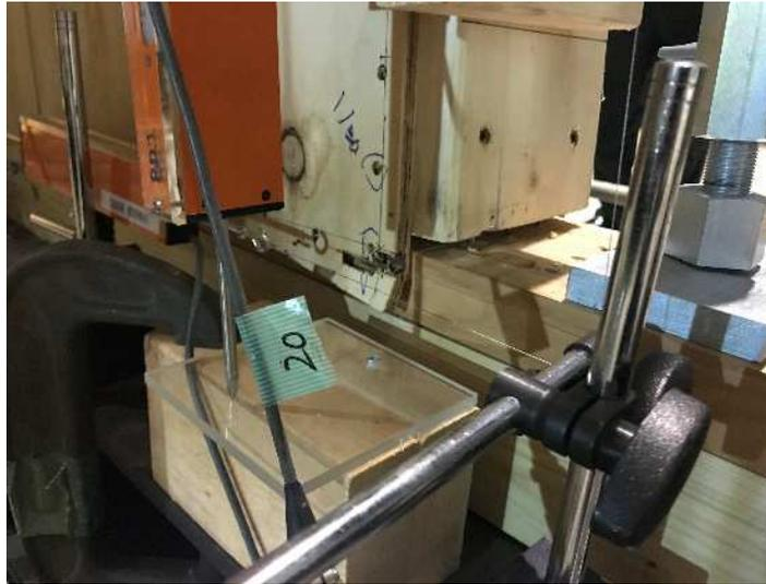
写真5.4-5 面材の縁切れ、たて枠の浮き上がり
