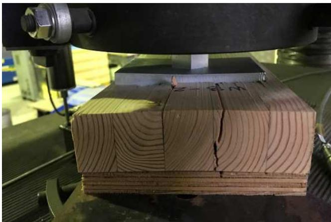
写真5.2-8 材の縦割れ (W13)
