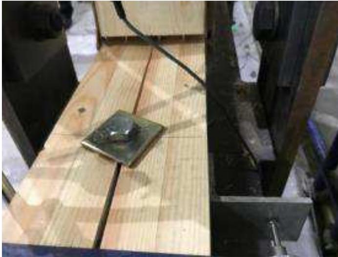
写真5.3-2 下枠の割裂
