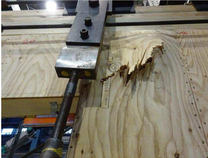
写真5.1-2 圧縮側面材の割れ (B-1)
