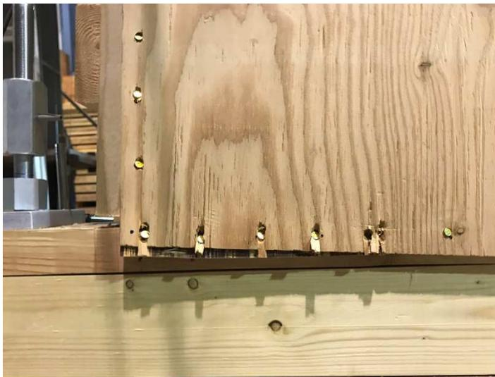
写真5.4-7 面材の縁切れ、パンチングアウト
