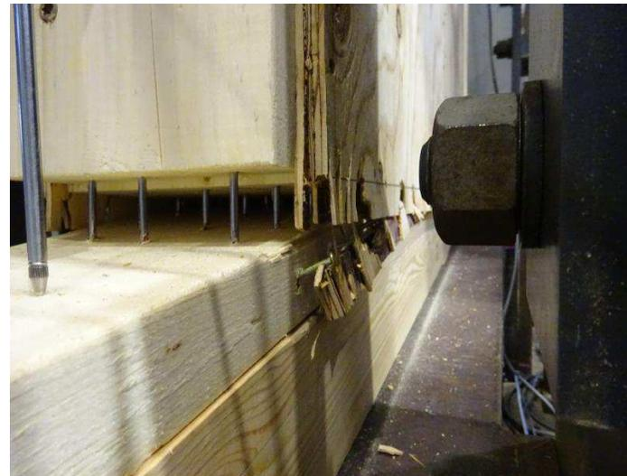
写真5.1-5 たて枠の浮き上がり、面材の縁切れ (B-1)
