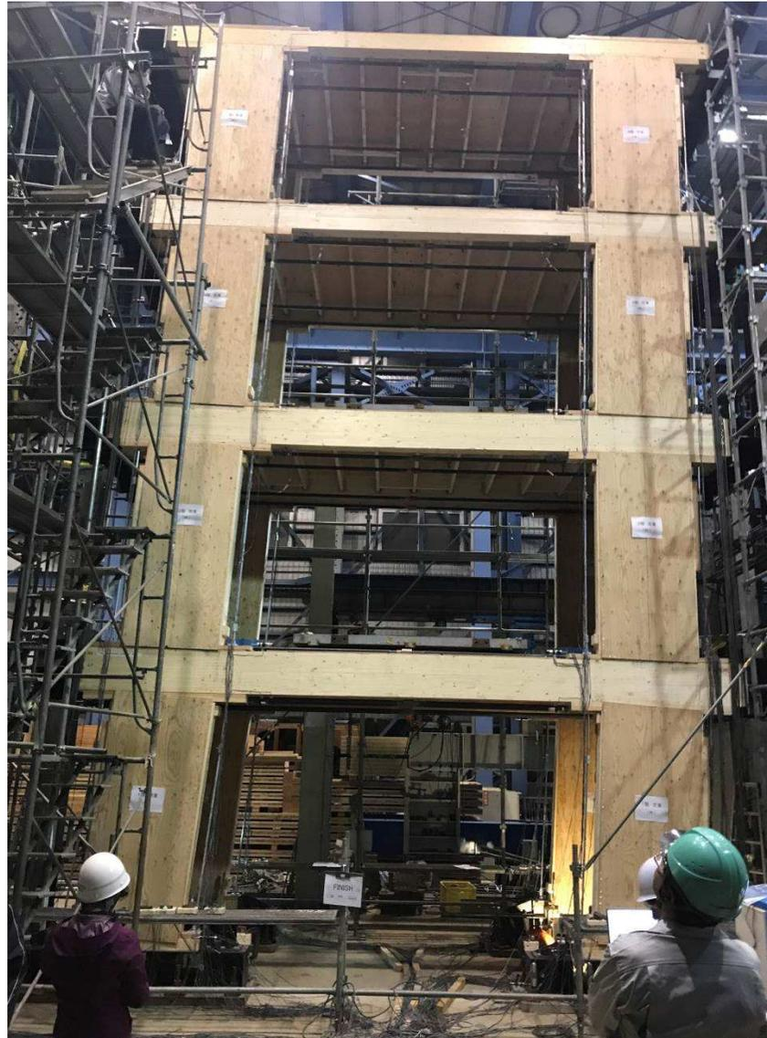
写真5.4-3 加力終了後（1/14rad時）の試験体全景
