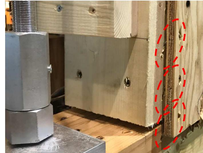
写真5.4-7 釘の枠材からの抜け
