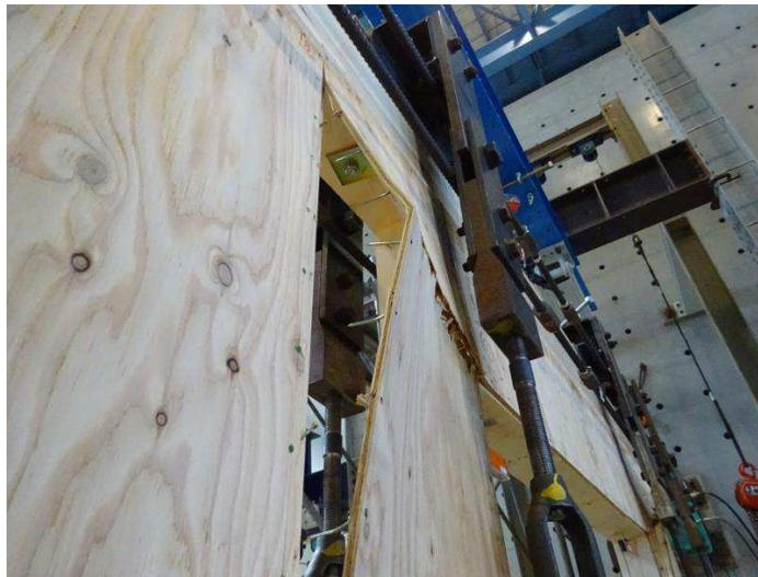
写真5.1-4 引張側釘の抜け (A-1)
