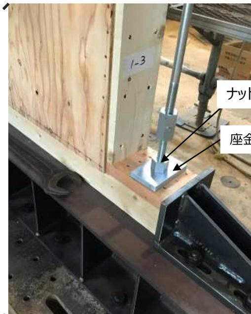
写真5.2-2 タイダウン設置例詳細
