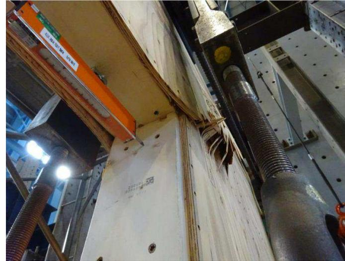
写真5.1-3 圧縮側面材の割れ (B-2)
