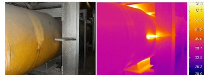
配管固定部からの熱損失
