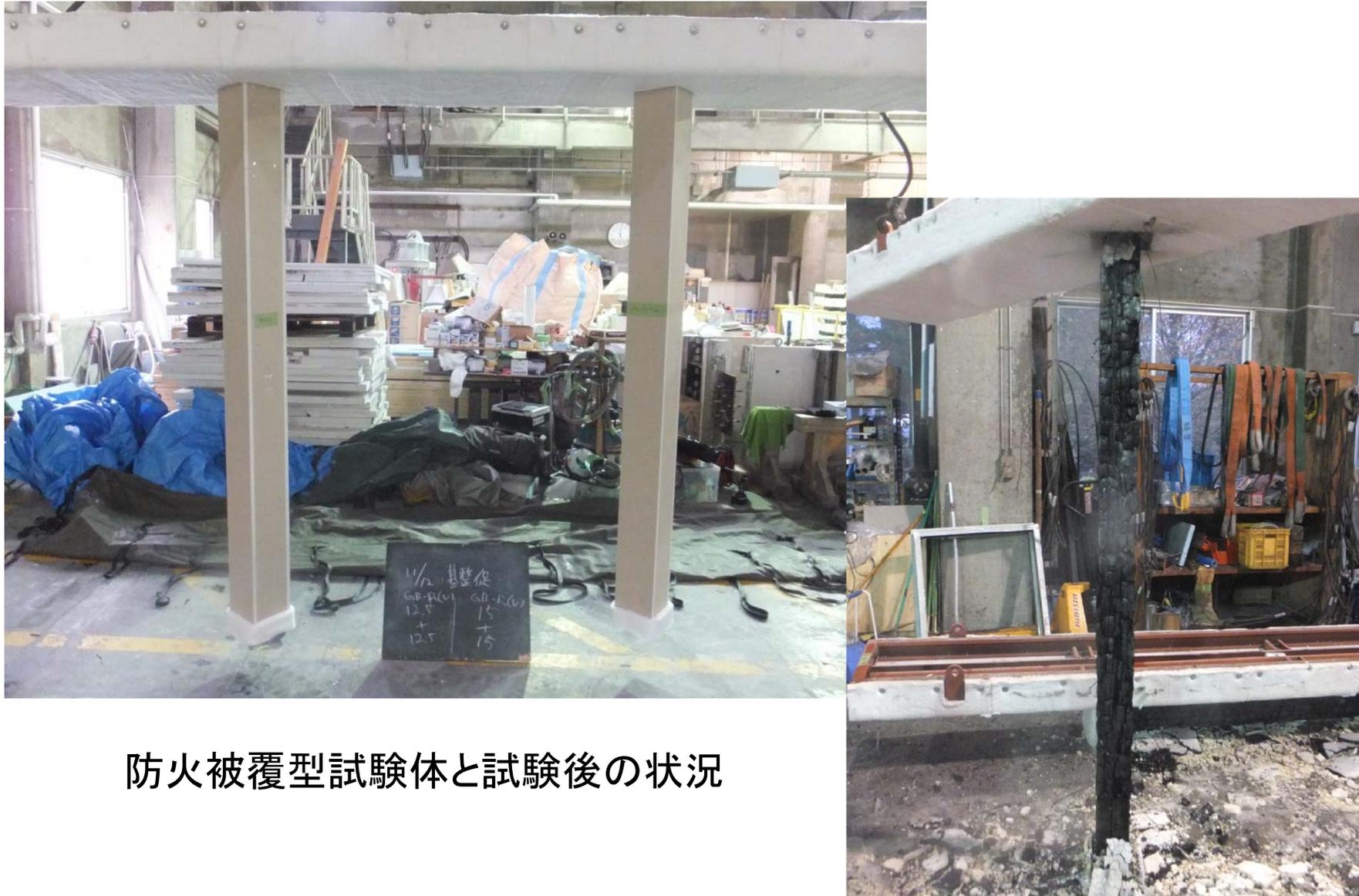
防火被覆型試験体と試験後の状況
