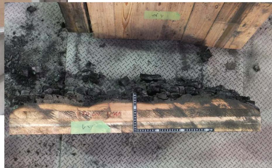
燃えしろ型試験体と試験後の状況
