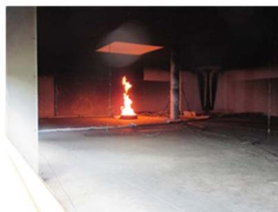
新検証法で用いる非定常煙降下時間算定式の精度向上を目的として、実大レベルでの時刻歴データ(煙層高さ、煙層温度、有効排煙量)の取得するために、180m<sup>2</sup>単室での煙流動実験を実施した。
