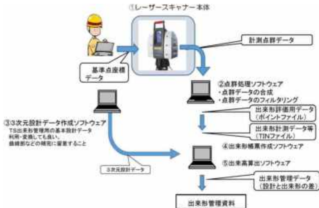
図 48 地上型レーザースキャナー（TLS）による出来形管理機器の構成例
