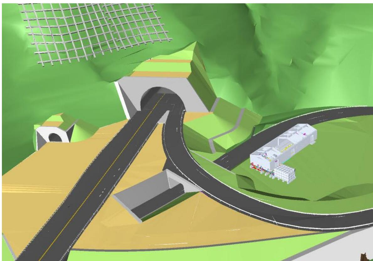
図 15 トンネル本体にポンプ室・電気室を重ねた統合モデル
