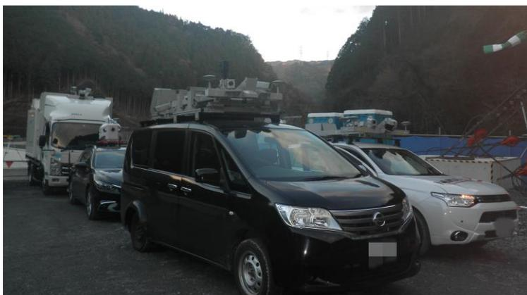
図 19 計測に使用した車載型レーザー 4 種
