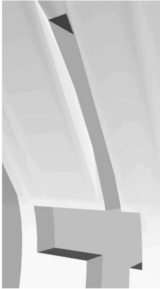
図 22 統合モデル上の箱抜き
