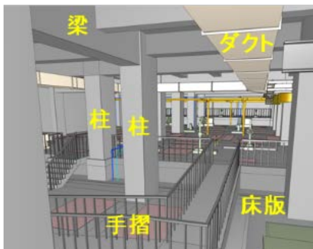
図 42 各部材によるモデル作成例
