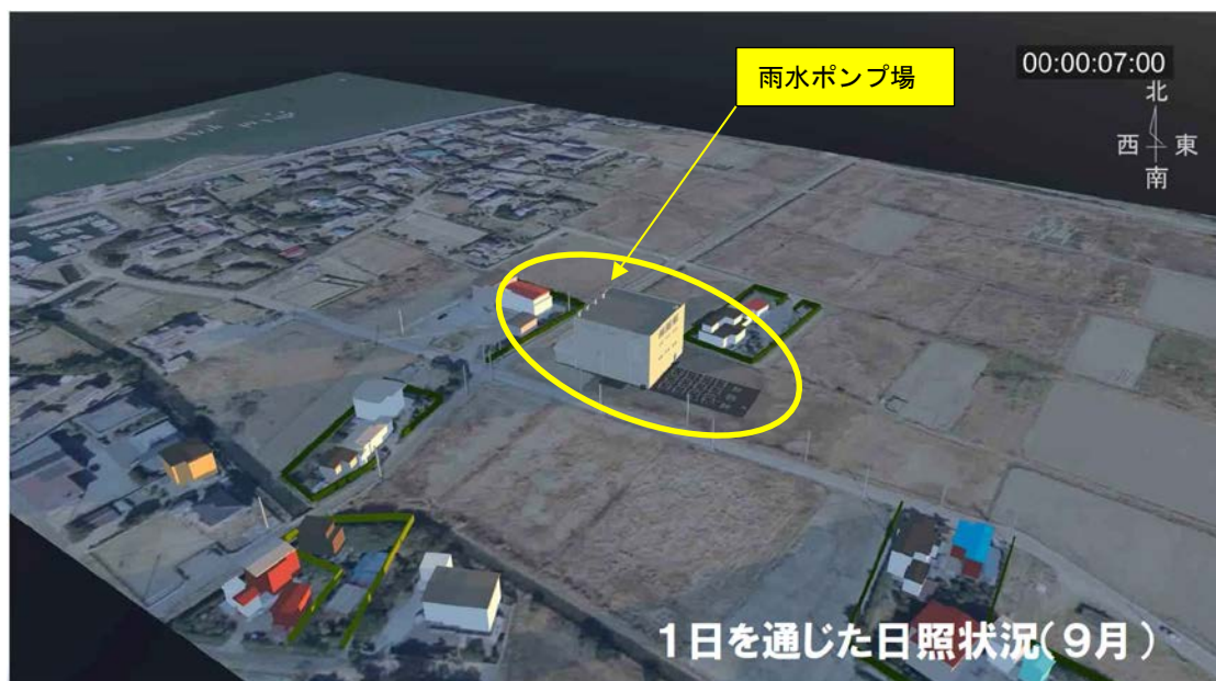
図 57 地形モデルと土木建築モデルを統合し日影検討に利用した例 (LOd : 30 相当)
