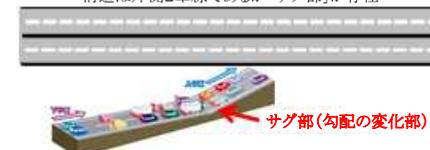
実際に流せる交通容量を表した構造イメージ(実容量1車線)
