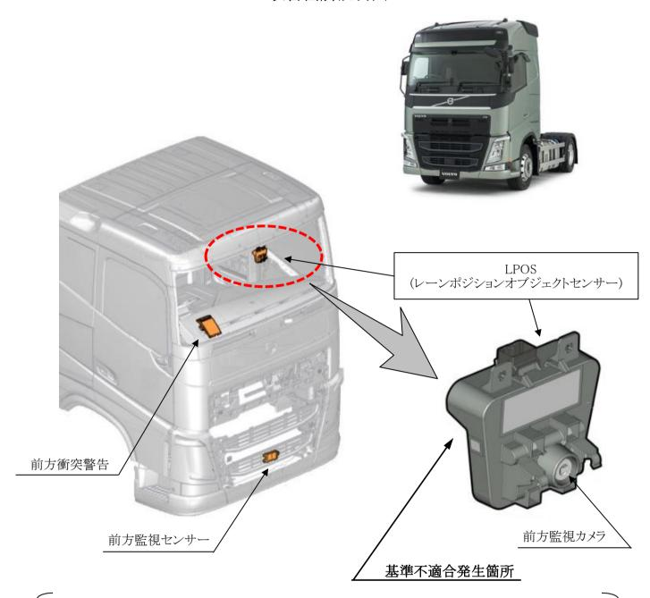
大型トラクタの衝突被害軽減制動制御装置において、LPOS(レーンポジションオブジェクトセンサー)のプログラムが不適切なため、超低速による旋回後の直進時に前方監視センサー及びカメラによる検知機能が低下することがあり、予期せぬ制動に至ることがある。そのため、保安基準第12条(制動装置の基準)に適合しなくなるおそれがある。
