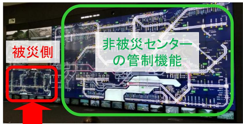
非被災センターの機能を維持したまま、被災した管制機能を切替える仕組み
