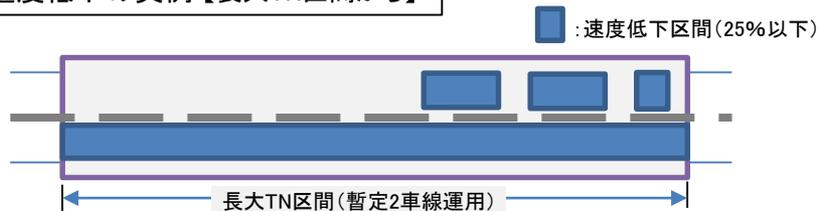
長大トンネル区間では、速度低下が顕著であり、縦断線形により上下方向の差はあるものの、約7割の範囲で速度低下が生じている場合もある。
