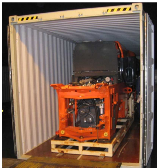
図表 4-3 コンテナに積載される 1.5t 超の貨物事例（建機のヘッド部分）
