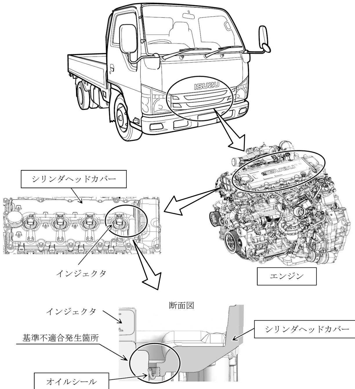
小型トラックのエンジンにおいて、シリンドラヘッドカバーの形状が不適切なため、インジェクタオイルシール部に雨水が滞留するものがある。そのため、オイルシールが膨潤してシール性が低下し、そのままの状態で使用を続けると、エンジンオイルが漏れ、最悪の場合、エンジンが損傷するおそれがある。
