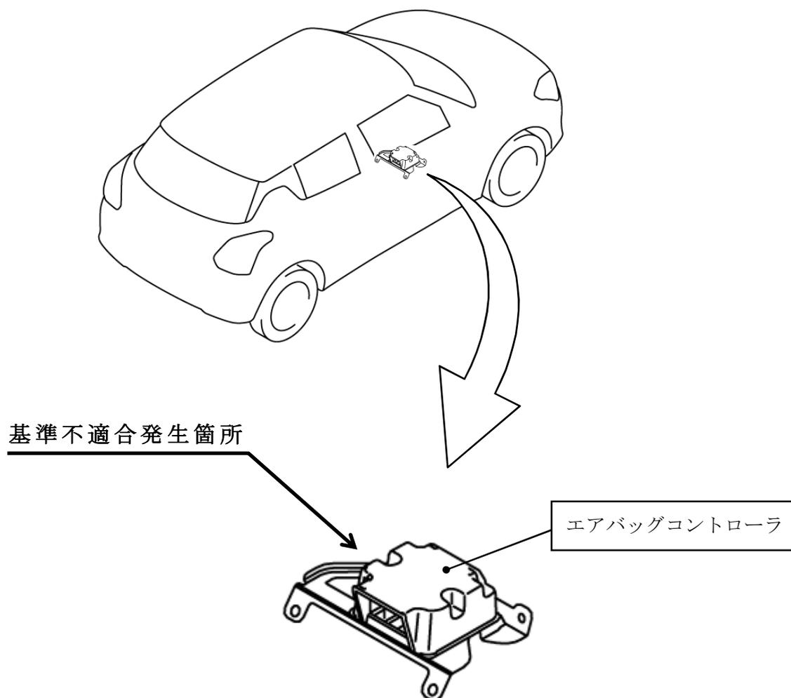
エアバッグコントローラの制御プログラムが不適切なため、後席ドアを強く閉めた際に、サイドエアバッグ、カーテンエアバッグ及びシートベルトプリテンショナーが誤って作動することがある。そのため、最悪の場合、エアバッグ展開時に乗員が負傷するおそれがある。
