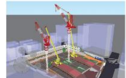
BIM施工ステップを現場に持出す
